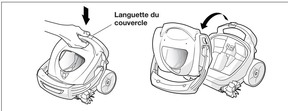
2. Appuyer sur le bouton de déverrouillage du couvercle du filtre pour retirer la cartouche du filtre.
