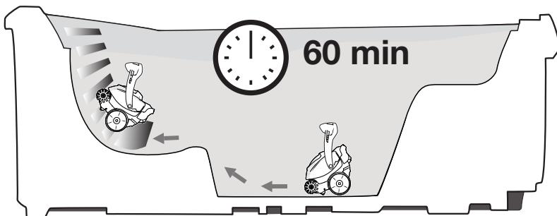
La unidad Spabot se desplaza de manera autónoma por el piso, los asientos y las paredes del hidromasaje para limpiarlo en solo 60 minutos.
