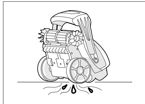
3. Mettre le nettoyeur sur le dos pour accélérer le drainage de l'eau.
