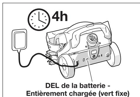
4. Lorsque la charge est terminée, le voyant de la batterie est vert fixe, indiquant une charge complète.
